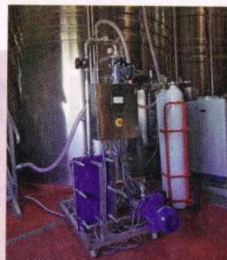
**LE SYSTÈME PILOTE LESSALCO** est composé d'un boîtier d'analyse du gaz fermentaire, d'un bulleur et d'un système de refroidissement. Il fonctionne en circuit fermé de façon automatique.
