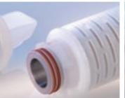
**Code 2:** ouvert d'un côté (SOE), 2-226 O-Ring, adaptateur baïonnette triple avec pointe de centrage, diamètre extérieur 44 mm (point le plus bas)
