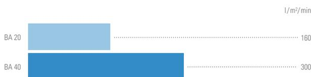
Conditions :  $\Delta p = 100$  kPa, sovlant : eau à 20 °C
