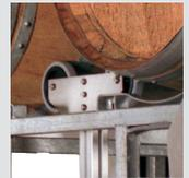
Nettoyage simultané de deux fûts. Ceux-ci posés sur le rack sont positionnés sur le nettoyeur avec un chariot élévateur. L'introduction de la tête gicleuse est effectuée manuellement. Un processus de nettoyage automatique avec nettoyage à l'eau froide/chaude, à la vapeur et l'égouttage est possible en fonction du niveau d'équipement.
