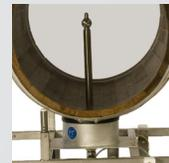
Installation de nettoyage de fûts avec chargement manuel des fûts. Le fût est chargé et basculé manuellement en position de nettoyage au moyen d'une rampe de chargement. Le modèle FR1C est en outre réglable, de sorte que des fûts jusqu'à 600 litres peuvent être nettoyés.
