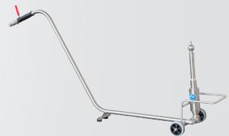
Nettoyeur de fût pour nettoyer un fût déposé sur un rack. La tête gicleuse est introduite depuis le bas dans le trou de bonde. L'eau sale s'écoule par gravité. Entraînement hydraulique à eau de la tête gicleuse permettant un nettoyage confortable.
